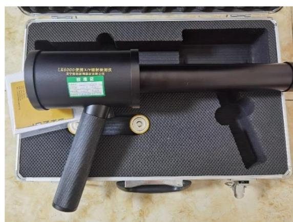
图 3-6 便携式 X、γ 辐射检测仪
