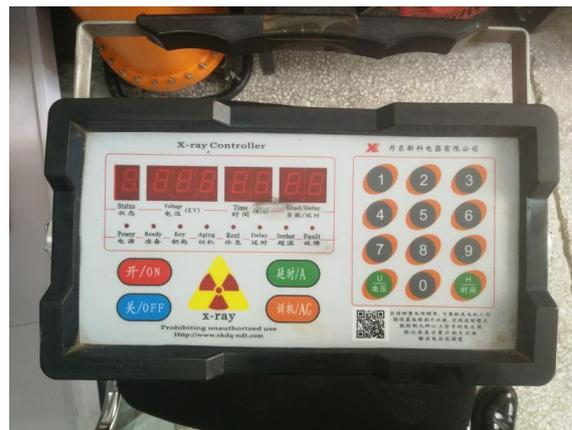
图 3-2 探伤机操作台操作界面
