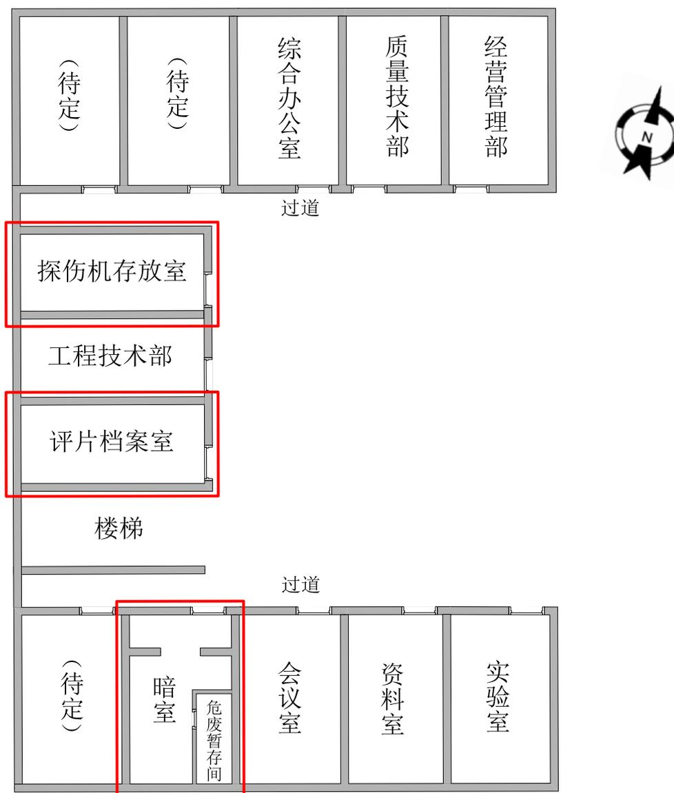
图 1-4 本项目探伤机存放室、暗室、评片档案室平面布置示意图
