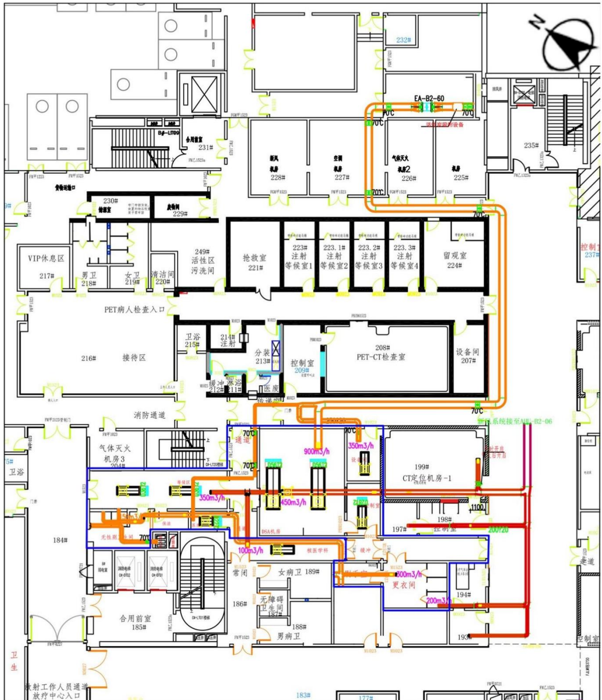
图 4-30 本项目 DSA 机房通风设计图
