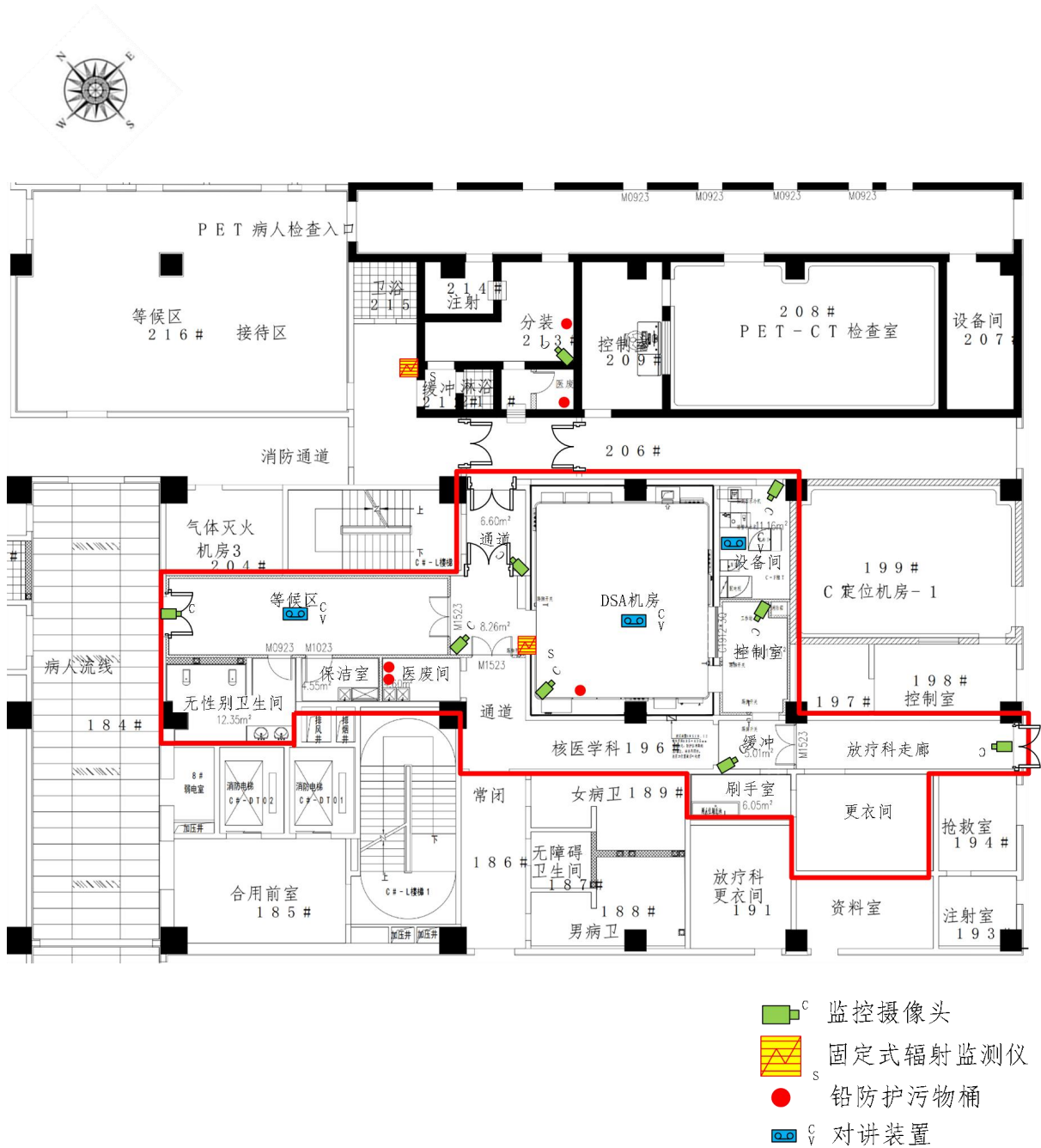
图 4-29 场所视频监控、对讲装置及铅废物桶位置
