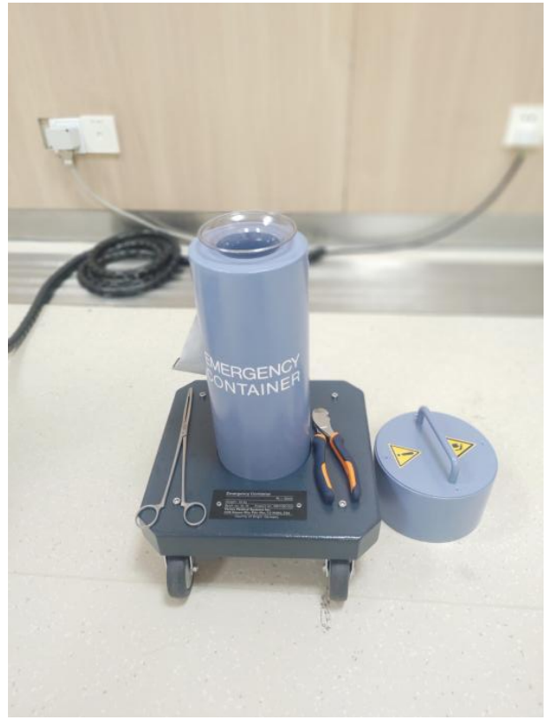
图 4-10 机房内应急储源桶和长柄镊子
