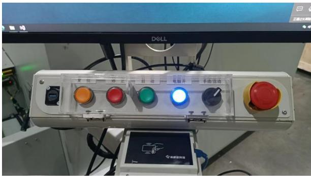
图 4-7 操作台停机按钮和控制锁
