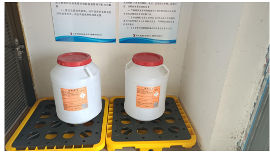
危废暂存间危废桶、防渗托盘
